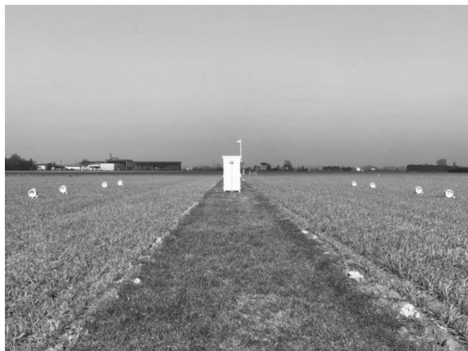
Figura 3. Prototipo con stazione e camere automatiche
